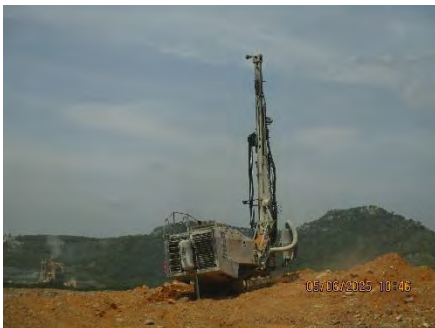
ภาพที่ 2-12 เครื่องเจาะระเบิดที่ติดตั้งเครื่องดักจับฝุ่นแบบถุงกรอง (Dust Collector)
