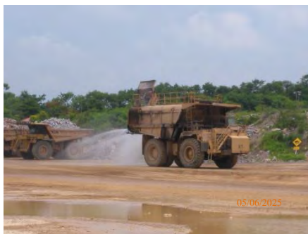
ภาพที่ 2-7 รถบรรทุกน้ำฉีดพรมน้ำเพื่อลดการฟุ้งกระจายของฝุ่นละออง
